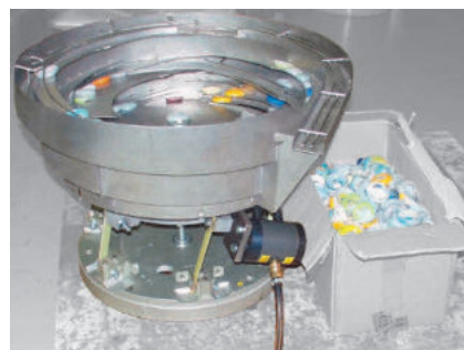
NTS 100/01 zum Wendelfördern von Schüttgut
