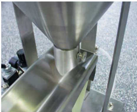
Dosierstützen am Behälterauslauf
