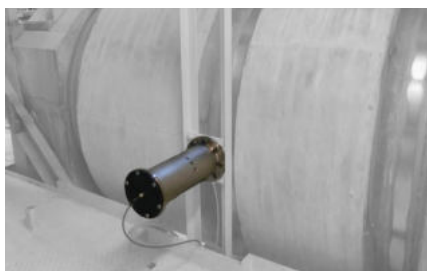
NHK zum Lösen von Anhaftungen an Drehrohröfen
