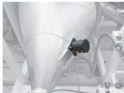
NTS 54/02 zur Verbesserung des Materialflusses
