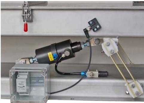
Vibrationsüberwachungssystem an Förderrinne mit Blattfedern
