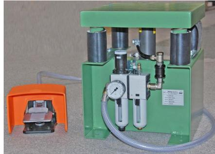
Wartungseinheit mit Kugelhahn und Verteiler
