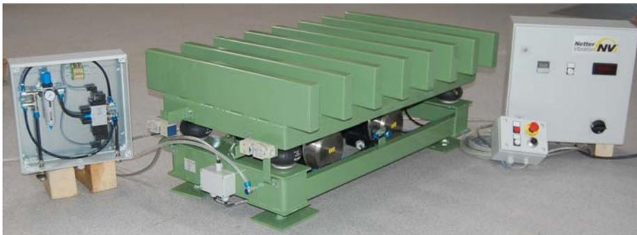
Wartungseinheit, Ein-/Ausschalter und Frequenzsteuerung am Vibrationstisch
