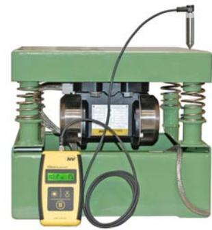
Frequenzmessung mit VibroScanner am Vibrationstisch
